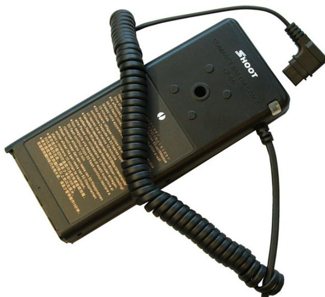
Le bloc porte pile s'introduit par l'avant dans le corps du booster, le système de verrouillage copié sur celui du Canon est peu agréable. En raison des contacts ressort des piles trop rigides il faut forcer de façon importante pour réussir à faire glisser la trappe en position fermée, la faible épaisseur des guides de verrouillage n'augure pas une résistance à tout épreuve. Ceci constitue sans doute le point le plus critique de cet appareil.
