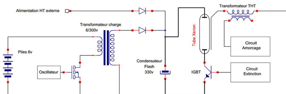
Le booster se relie au flash par un connecteur standardisé trois points. Deux sorties délivrant la tension de 300v environ servant à charger le condensateur du flash, une entrée 3 à 5v permet au flash de mettre en fonctionnement le booster. La mise en veille du booster est alors asservie à celle du flash.
