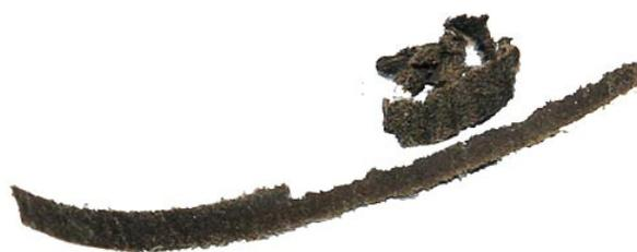
La pièce d'origine référencée YA2-3642-000 comprenant la feutrine collée sur le segment conique en acier coute environ 40€ TTC mais est introuvable hors sav, la durée de son remplacement ne doit pas dépasser une heure, le démontage de l'ensemble de serrage décrit au chapitre dépoussiérage optique ne demandant qu'une dizaine de minutes.
