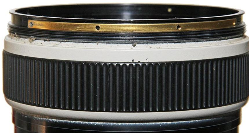
Le corps de l'ensemble de serrage est muni d'une gorge recevant une pièce en laiton vissée sur la bague de réglage et venant en butée sur un plot. Cette pièce limite la course de la bague de réglage de la pression de serrage à  $\frac{3}{4}$  de tour. Les quatre trous taraudés de la pièce en laiton conjugués aux cinq de la bague de réglage permettent d'ajuster par leur choix lors du montage des deux vis de fixation la pression maximale permise sur la feutrine.
