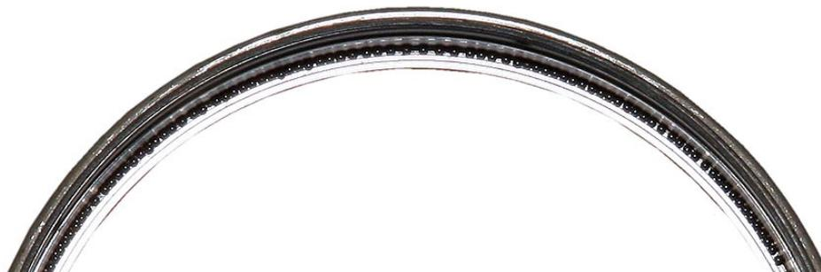
La perte de quelques billes n'est pas trop critique, si un nombre plus important est perdu deux ou quatre spacers constitués de fil de cuivre de 1mm aux extrémités rectifiées peuvent être utilisés pour compenser. Si trop de billes sont perdues il est préférable de remplacer l'ensemble de celles-ci, des lots de 1000 billes acier étant trouvables sur Ebay.com pour une quinzaine d'euros.
