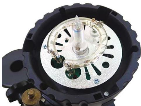
Le flash utilise un classique tube annulaire Xénon relié au circuit imprimé par des douilles banane classiques soudées au bout des longues tiges de sortie du tube. Leur extraction pourra être délicate, en cas de forçement excessif il sera préférable de démonter la plaque réflectrice et d'agripper directement et alternativement les douilles banane avec une pince à bec long pour ne pas forcer sur l'extrémité en verre du tube au risque de le fêler.
